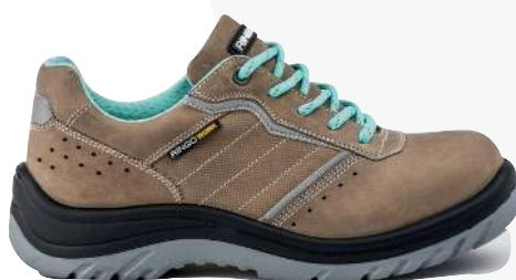
WKIT0024 Cuero flor gamuzado acolchado, suela multidensidad, plantilla antimicótica, puntera de aluminio, dieléctrico.
